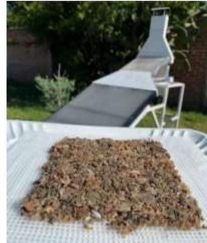
Figura X. Secador solar tipo gabinete con colector solar
